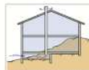
Figur 3. Tætning af bygning med krybekælder. Det er vigtigt at sikre, at krybekælderens afslutning er afsluttet via en kasse (3) og en afslutning i kassen (4) og en afslutning i kassen (5).
