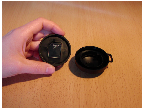
Figur 6.1 Dosimeter til måling af radonniveau. Dosimeteret er åbnet så sporfilmen kan ses.
